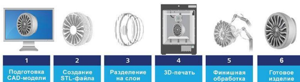
Рисунок 1- Additive Manufacturing (3D Globaltec)
